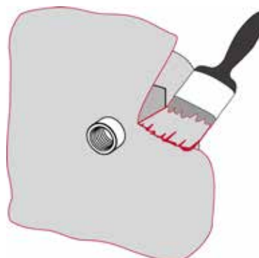
Рис. 3. Нанесение верхнего гидроизоляционного слоя
