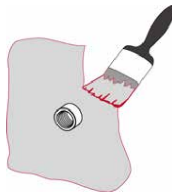
Рис. 1. Нанесение нижнего гидроизоляционного слоя
