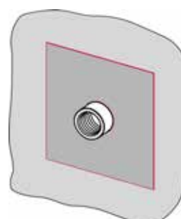
Рис. 2. Вдавливание уплотнительной манжеты во влажный гидроизоляционный слой
