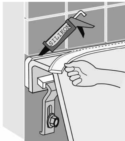
Герметизация звукоизоляционной лентой и силиконовым швом
