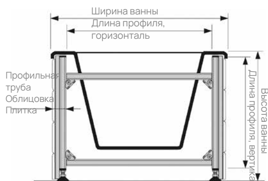
Точный расчёт длины/ширины для отдельно стоящих ванн
