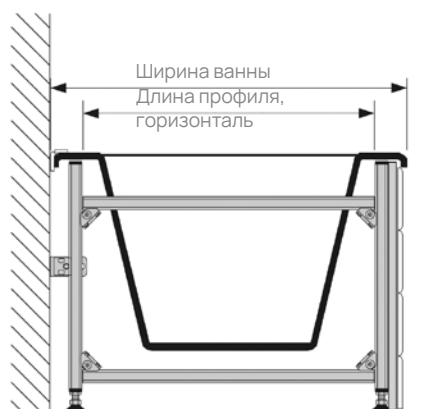
Точный расчёт длины/ширины для отдельно стоящих ванн
