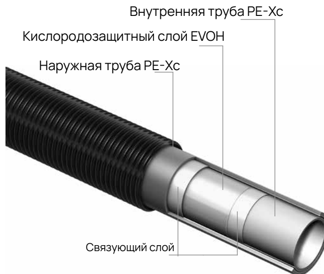
Строение трубы TECEflex PE-Xc 5S
