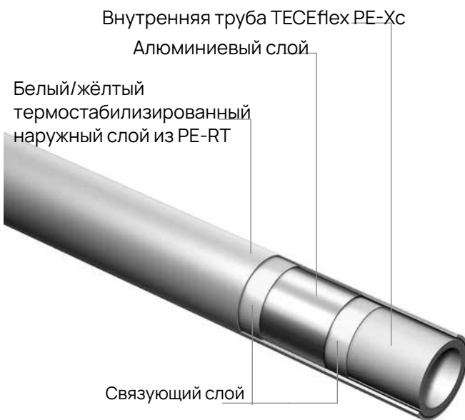
Строение металлопластиковой трубы TECEflex
